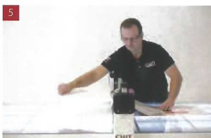
2 被着体と粘着シートを重ね、位置合わせをします
