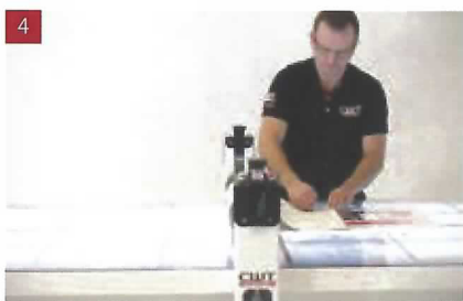
4 粘着シートのセパ紙を半分ほど剥がします
