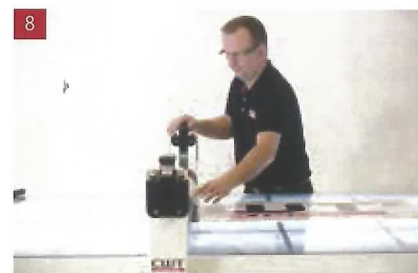
8 ローラー ハンドルを押すと、ローラーが転がり貼り付けが完了します
