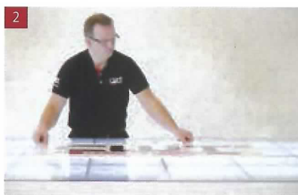
2 被着体と粘着シートを重ね、位置合わせをします
