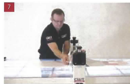
7 セパ紙をローラーの下に折り込みます
